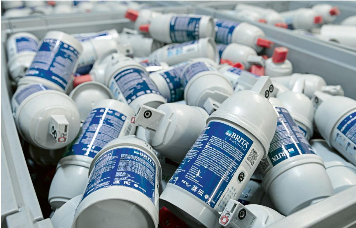
Das Familienunternehmen BRITA produziert seit 1966 Wasserfiltersysteme für Gewerbe und private Nutzer. Ein wichtiger Bereich im Produktportfolio sind Filtersysteme für Gewerbekunden. Der Purity C Filtertyp ist eine spezielle Filterlösung für gewerbliche Anwendungen etwa im Bereich der Gastronomie und arbeitet auf Basis des Ionentauscherprinzips. Daher muss die Filterkartusche, abhängig vom Einsatz und Gebrauch, nach ca. einem Jahr ausgetauscht werden.
